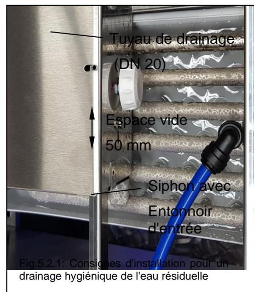
Les appareils refroidis à l'eau ont un tuyau de vidange supplémentaire. Celui-ci doit être connecté au réseau d'égouts **à l'extérieur** de la machine. Ne mettez pas ce tuyau dans le conteneur de stockage!
