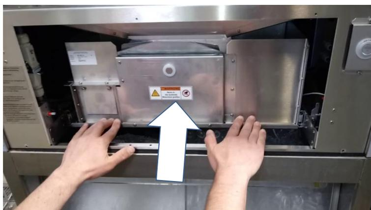
8. Fermez le verrou du mécanisme d'extraction sur la gauche
